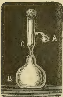
Fig. 7. Kasperek's Apparat zur Züchtung von Anaëroben. A. Kugel mit Paraffin. Nach dem Impfen wird das Paraffin in A verflüssigt und schliesst bei C die in B befindliche Cultur luftdicht ab.
